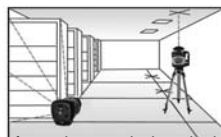
Referencia para la instalación de molduras y localización de lámparas de techo
