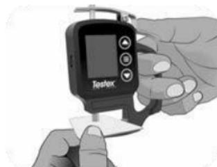
**NOTA:** Limpiar los yunques antes de encender el medidor, de reiniciarlo (pág. 6) o cada vez que el instrumento no indique  $-50 \mu\text{m}$  ( $-2,0$  mils) al retirar la cinta de réplica tras realizar una medición.
